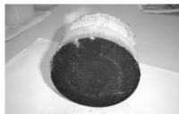
Figura 9: Catalisador usado totalmente contaminado com fuligem. [Figure 9: Used catalyst contaminated by soot.]
